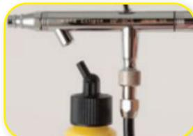
**1b.** Remplir une bouteille propre (non inclus) avec le Medea Airbrush Cleaner (ou un nettoyant approprié) et fixez-la à l'aérographe.
