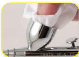
**1c.** Versez le nettoyant ou de l'eau dans l'aérographe jusqu'à ce qu'il vaporise clair. Vaporisez dans un pot de pulvérisation ou sur un papier absorbant.
