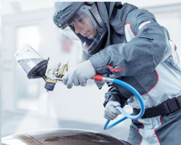
Le SATAjet X 5500 assure une pulvérisation homogène pour un niveau de finition hors pair
