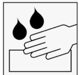
Appliquer un **primaire garnissant** (apprêt) en pot ou en spray, avec autant d'épaisseur que nécessaire pour couvrir les défauts. Permettre un séchage complet de l'apprêt (2h à 20°C). Réaliser un ponçage avec une calle à poncer est un grain abrasif de P500.
