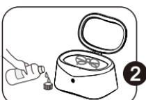
Pour le nettoyage professionnel, un détergent de nettoyage spécial peut être utilisé. Découvrez le niveau concentré qui convient à vos objets à nettoyer et le type de contamination.
