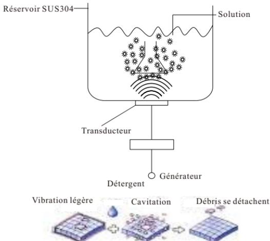
Le nettoyage ultrasonique est basé sur l'effet de cavitation provoqué par la vibration des ondes ultrasoniques à haute fréquence dans le liquide. Les bulles microscopiques se forment. Ces implosions provoquent la cavitation qui crée une action de frottement intense sur la surface de l'article en cours de nettoyage. Les bulles sont suffisamment petites pour pénétrer dans les crevasses microscopiques, en les nettoyant soigneusement et uniformément.
