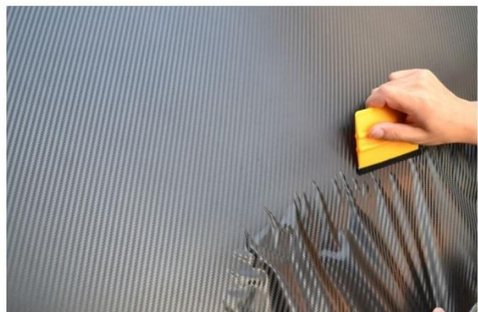
8. À l'aide d'un pistolet à air chaud ou un sèche-cheveux enroulez le film vinyle dans les bords
