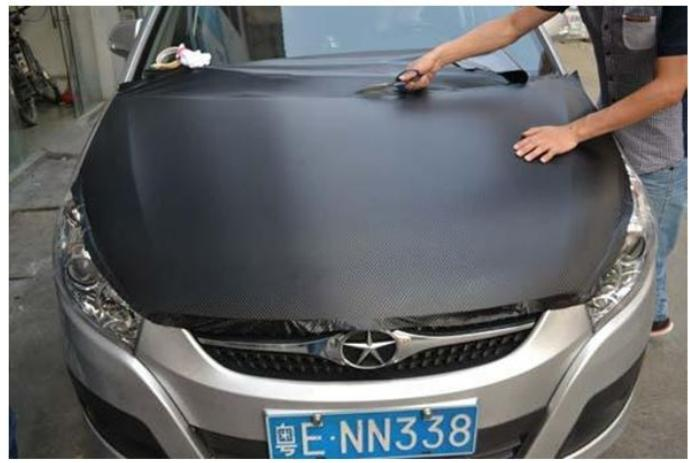
10. Enroulez le film vinyle vers l'intérieur des bords à l'aide d'un pistolet à air chaud
