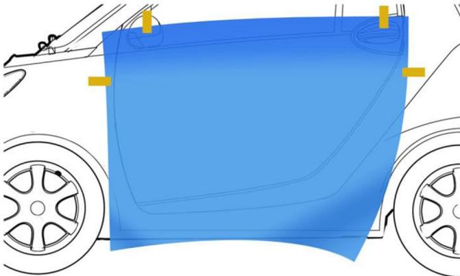
Placez la bande de vinyle sur la surface plane, sans enlever la pellicule de protection. Fixez la bande vinyle avec des morceaux de ruban adhésif pour la maintenir en place. Utilisez le support pour éliminer tout excédent de film autour de la zone.
