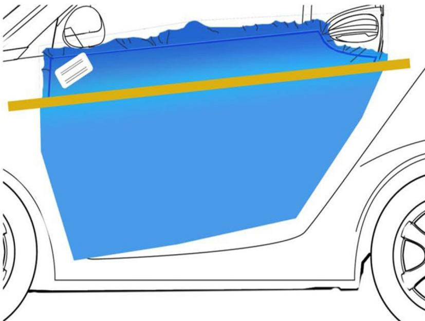
2.4 Une fois la pellicule enlevée, remplacez le vinyle et faites-le adhérer sur la surface à l'aide d'une raclette en feutre. Utilisez la chaleur et la pression si nécessaire.
