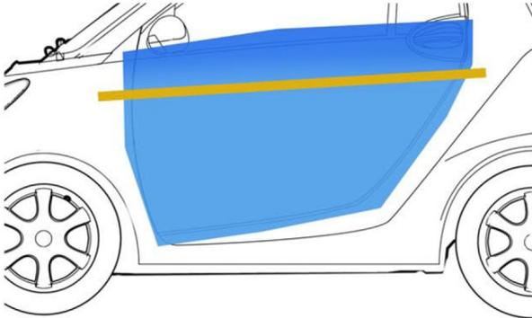
2.1 Collez une bande de ruban de masquage en travers du vinyle afin de le redresser et faciliter l'application. Retirez les autres morceaux de ruban adhésif une fois le film solidement maintenu en place.
